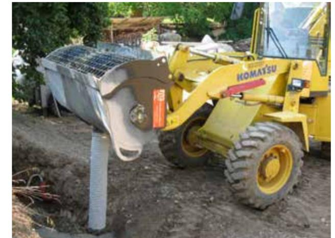
Betonmischschaufel am Radlader
