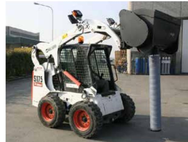
Betonmischschaufel am Kompaktlader
